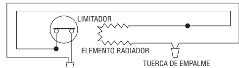
Figure 6. Conexiones del alambrado del calentador
